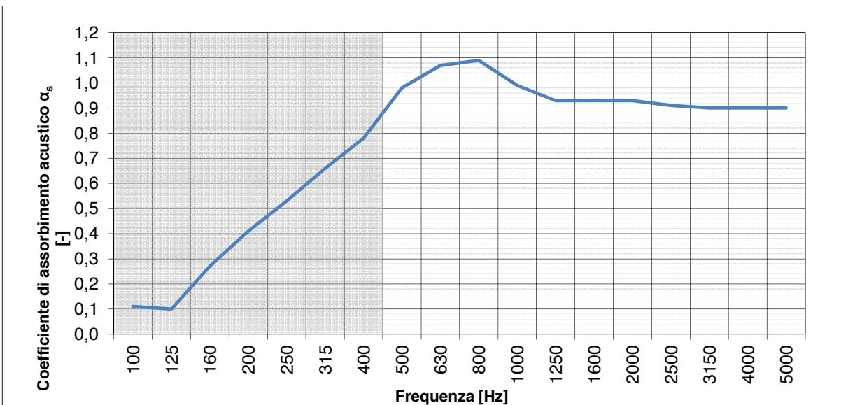
La misura dei coefficienti di assorbimento acustico in camera riverberante è avvenuta in conformità con la norma UNI EN ISO 354:2003.
