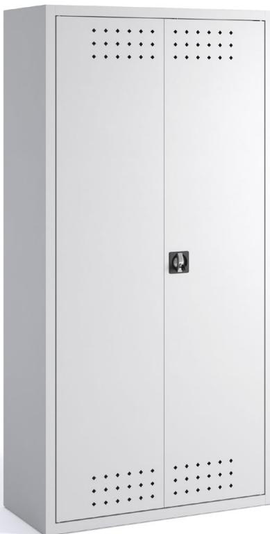
**Ante battenti:** in lamiera di acciaio presso piegata con 2 cerniere ad innesto “invisibili”, apertura a 110°, maniglia incassata quadra in ABS con serratura integrata a 2 punti di chiusura top e base con doppia chiave pieghevole anti-infortunistica. Gli armadi sono verniciati con polveri elettrostatiche di resine epossipoliestere, previo trattamento di fosfogassaggio.
